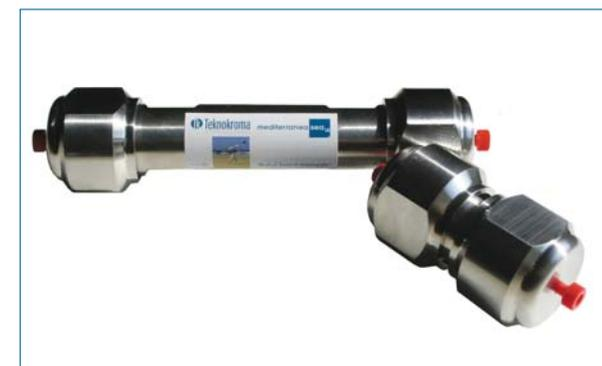
La columna **mediterranea sea<sub>18</sub>**, además de su comportamiento absolutamente inerte y su amplio rango de pH's de trabajo, se caracteriza por su elevada capacidad de carga, consecuencia del proceso SEA (Surface Enhanced Accessibility) de formación de poro en la partícula de sílice.
